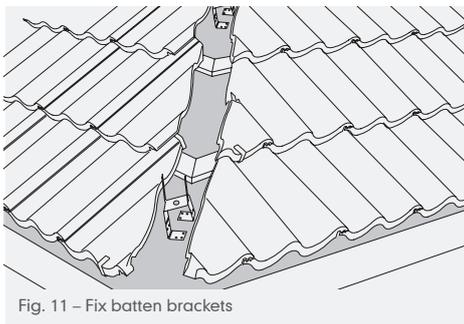
Fig. 11 – Fix batten brackets
